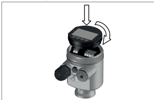
Fig. 48: Colocação do módulo de visualização e configuração na caixa de uma câmara no compartimento do sistema eletrónico
