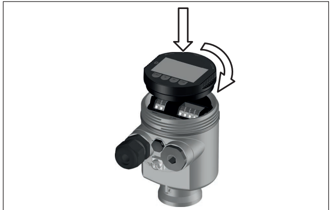
Abb. 48: Einsetzen des Anzeige- und Bedienmoduls beim Einkammergehäuse im Elektronikraum
