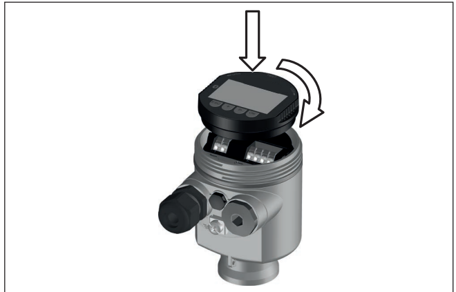
Fig. 48: Empleo del módulo de visualización y configuración en carcasa de una sola cámara el compartimiento de conexión
