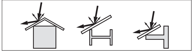
Fig. 29: Tapar los perfiles lisos con pantallas dispersoras
